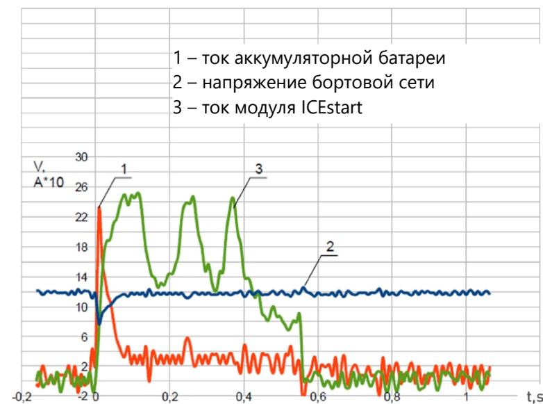
1. При штатной схеме пуска средний разрядный ток аккумуляторной батареи составляет 230 А, среднее напряжение бортовой сети - 9V, длительность пуска - 0,68с.
