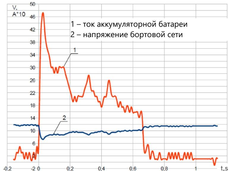
**Осциллографмы пуска ДВС от аккумуляторной батареи 30Ah и модуля ICEstart®**
