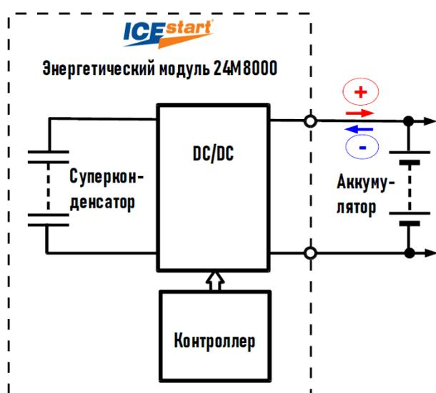
Рис. 1 Блок-схема
